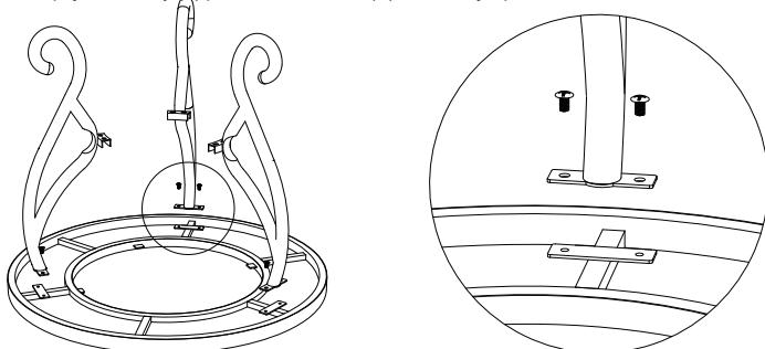
KROK 3 - Upevněte středový kruh (5) pomocí 6 x šroubů (B) a 6 x matic (C). Utáhněte všechny upevňovací prvky.
