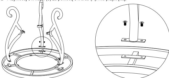
KROK 3 - Przymocuj pierścień środkowy (5) za pomocą 6 śrub (B) i 6 nakrętek (C). Dokręć wszystkie mocowania.
